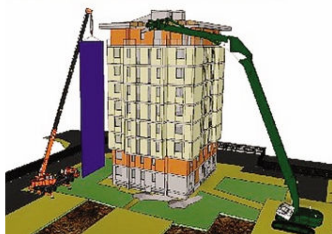
La demolizione sarà effettuata con una ruspa dotata di braccio mobile
